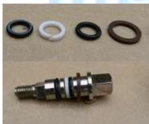
Une bague anti-extrusion est blanche (Teflon) et souvent fendue à 45°. Toujours accolée à un joint torique, elle est du côté extérieur
