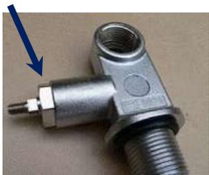
Serrage de l'écrou presse-étoupe à 40 Nm pour éviter un desserrage intempestif
